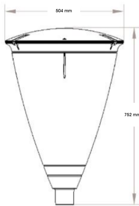
LUMINARIA SCHREDER MODELO FLEXIA TOP 37.8 Y 68 W Escala 1:10
